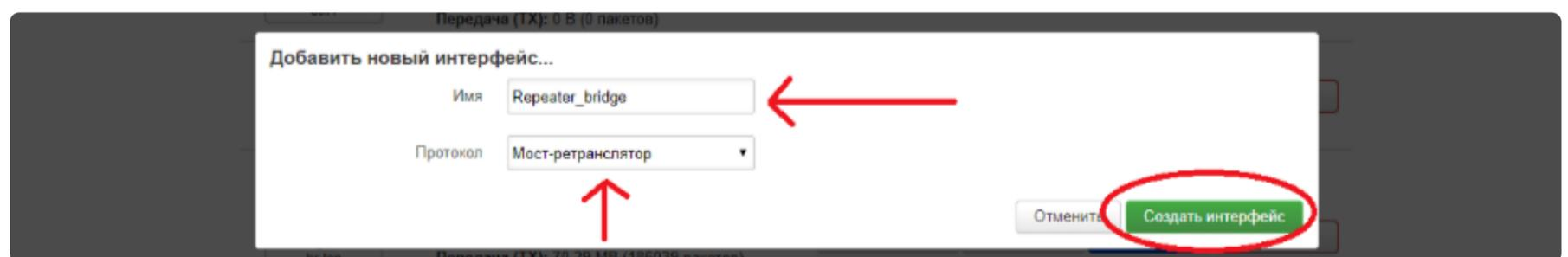
В разделе **имя** вводим **Repeater\_bridge**, а **протокол** выбираем **Мост-ретранслятор**, после чего нажимаем на кнопку **Создать интерфейс**.
